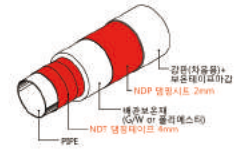
배관 방음 LAGGING 설치
